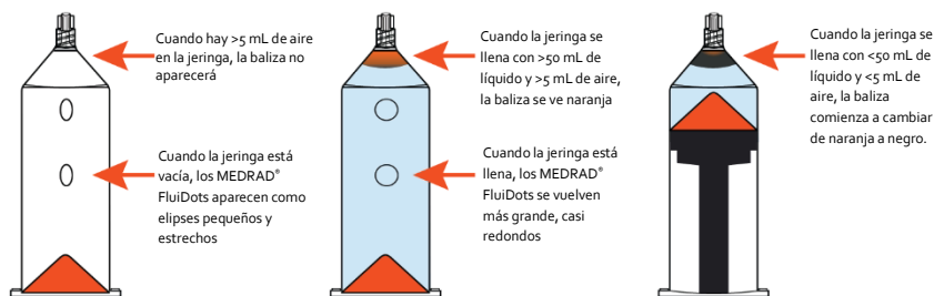
Figura 1. Tecnologías de detección visual de aire. Los MEDRAD® FluiDots cambian de elipses en una jeringa vacía a puntos redondos en una jeringa llena. La tecnología de baliza indica la presencia de líquido en una jeringa vertical al reflejar el color del émbolo en la punta de la jeringa. El color de la baliza se oscurecerá a medida que disminuya el volumen de líquido en la jeringa.
